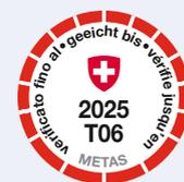
Diese Eichmarke wird für Messmittel verwendet, bei denen die Eichgültigkeitsdauer mehr als vier Jahre beträgt. Die Eichung im Beispiel ist gültig bis 31. Dezember 2025. Die vom METAS ermächtigte Eichstelle mit der Nummer T06 hat die Eichung durchgeführt.
