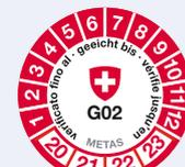
Diese Eichmarke wird für Messmittel verwendet, bei denen die Eichgültigkeitsdauer bis zu vier Jahre beträgt. Die Gültigkeit wird mit Lochmarkierungen im Ablaufmonat und -jahr angegeben. Die Eichung wurde durch die vom METAS ermächtigte Eichstelle mit der Nummer G02 durchgeführt. Diese Eichmarke wird auch bei Mengenumwertern eingesetzt.
